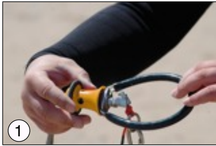
1 Der Auslöser muß zum Öffnen des Systems nach oben geschoben werden.
