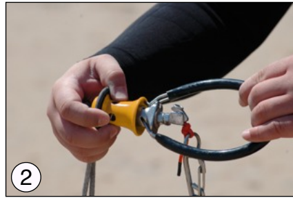
2 Dadurch wird der Sicherungsstift aus der Arretierung gelöst.
