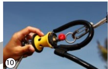
den Auslöser wieder in die Ausgangsstellung zurück gleiten lassen.
